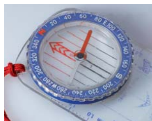
Крајот на магнетната игла обележан со црвено се насочува кон север.
