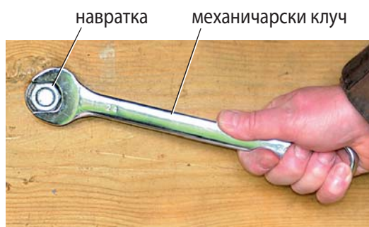
Затегнување навртка со механичарски клуч.
