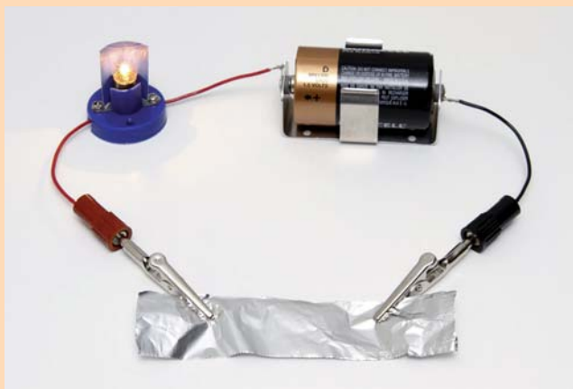
Проверка на спроводливоста на парче алуминиумска фолија.
