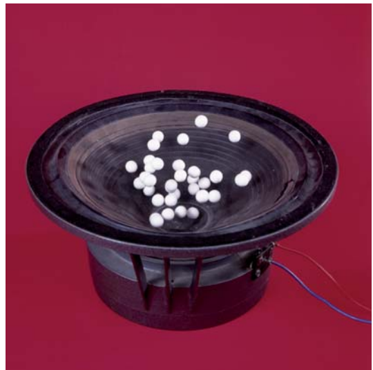
Конусната мембрана на звучникот осцилира.
