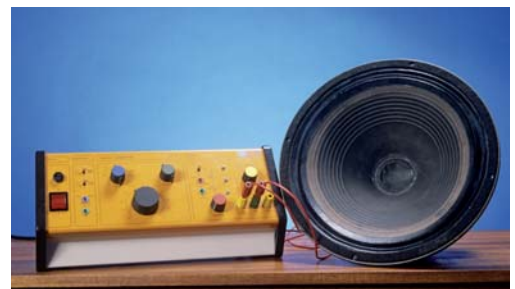
Сигнал-генераторот произведува тонови со различна фреквенција.
